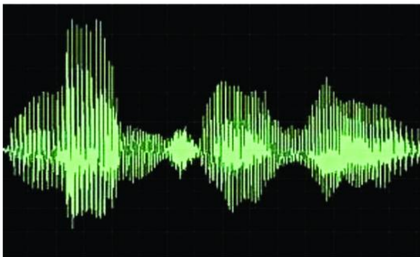
图1-7 多频率组合波形示意图
